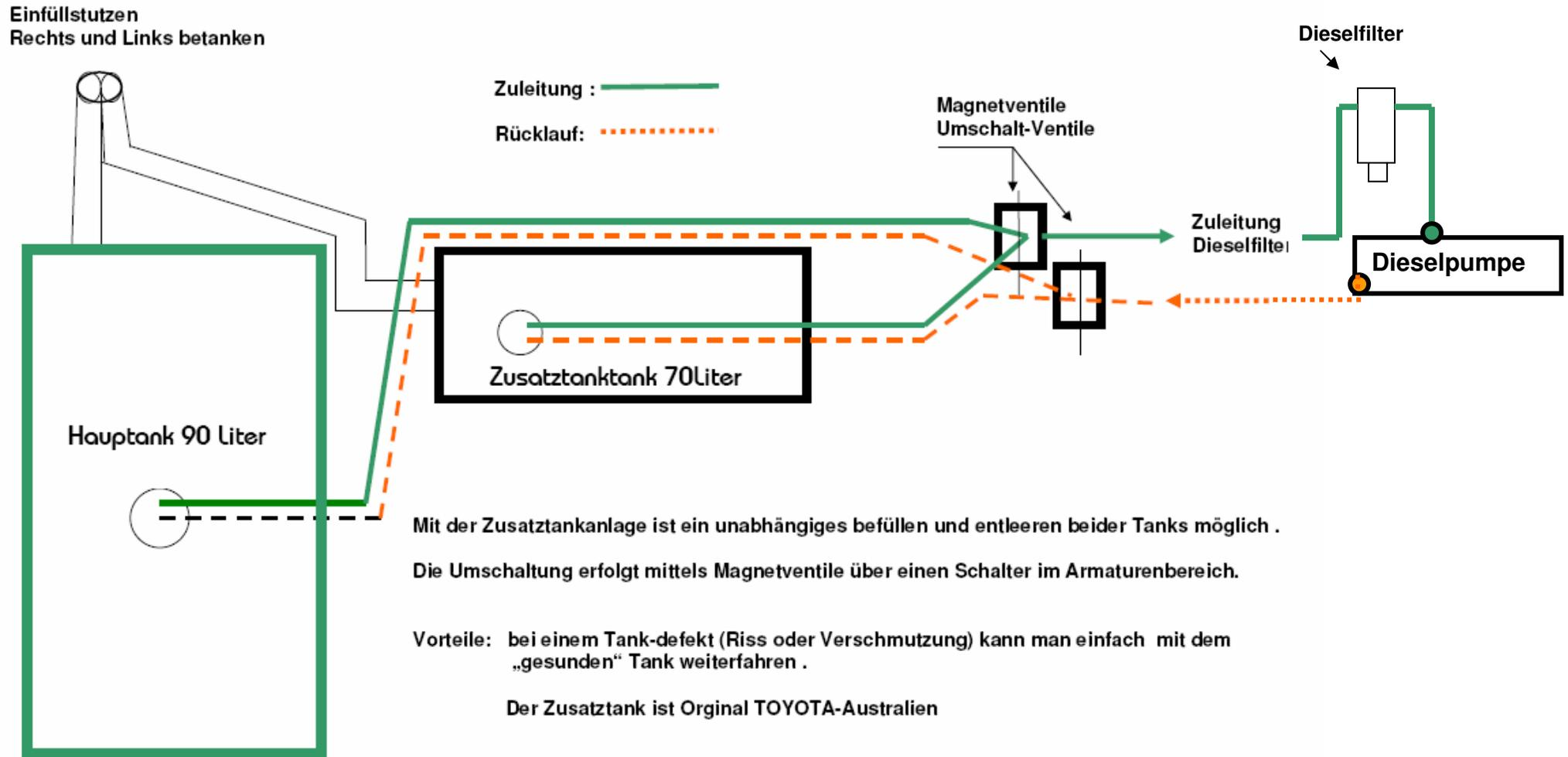
Mit der Zusatztankanlage ist ein unabhängiges befüllen und entleeren beider Tanks möglich .
